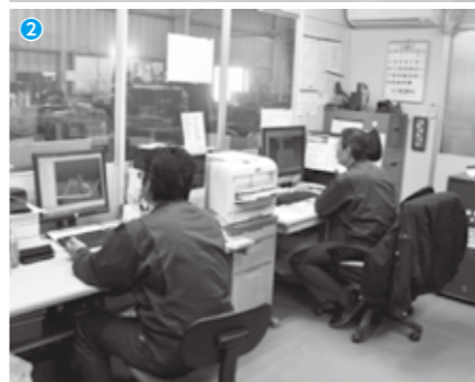
①工場の外観 ②金型の設計作業の様子。顧客からのオーダーに応じたさまざまな金型が設計されている。③金型の製造やメンテナンスの現場 ④製造された金型 ⑤プレス加工作業の様子。金型を取り付けて金属部品へと加工する。⑥さまざまな工程を経て完成した乗用車刈り機の部品
