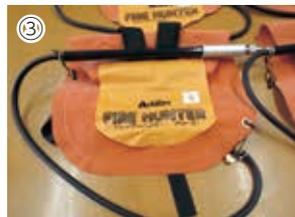
①平野区自主防災会が整備した発電機②平野区自主防災会が整備したエンジンチェンソー③和水町消防団に配備した背負い式消火水のう
