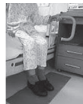
足が床敷のセンサーマットに触れると、 警報で知らせます。
