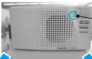
電池ランプが赤色で点滅したら、電池交換のサインです。
