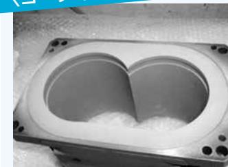
品 名：DRYポンプ用ケーシング 使用場所：半導体製造装置
