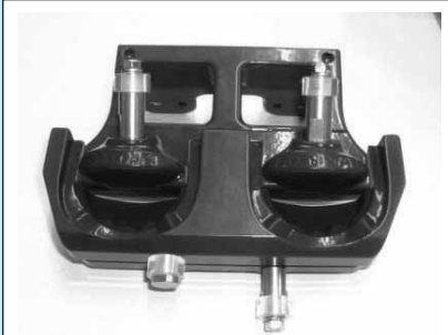
品名：餃子成型金型 使用場所：食品製造工場
